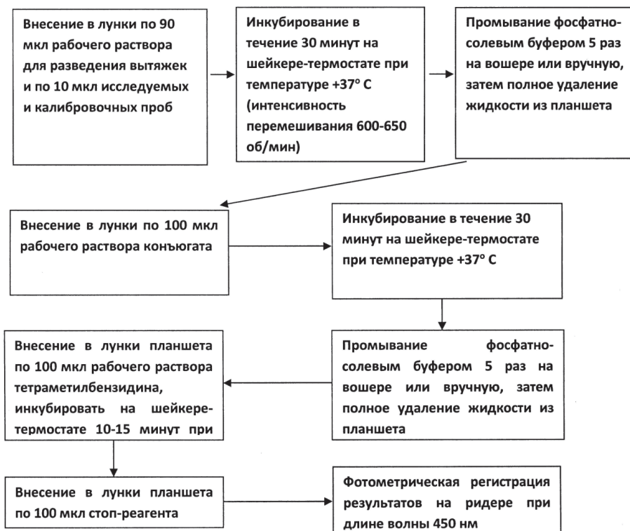
Рис. 1. Алгоритм установления видовой принадлежности биологических объектов по IgG общ методом количественного иммуноферментного анализа
