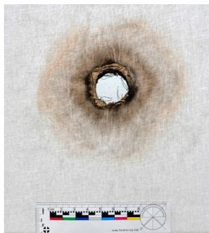
**Рис. 17.** Повреждение ткани с подложкой из ДСП при выстреле с расстояния 50,0 мм
