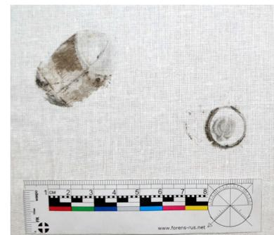
**Рис. 22.** Отпечатки пули и пыжа на ткани с подложкой из ДСП при выстреле с расстояния 5000,0 мм
