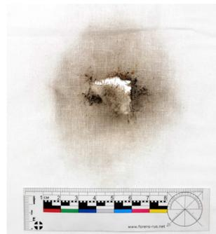
**Рис. 3.** Повреждение ткани без подложки при выстреле с расстояния 50,0 мм
