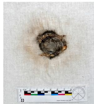
**Рис. 18.** Повреждение ткани с подложкой из ДСП при выстреле с расстояния 100,0 мм
