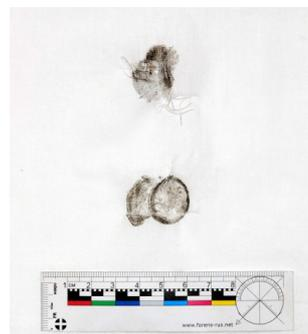
**Рис. 7.** Повреждение ткани без подложки и отпечаток на ней пули при выстреле с расстояния 3000,0 мм
