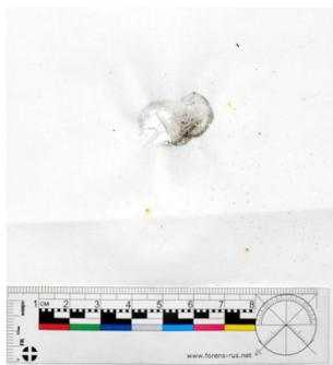
**Рис. 6.** Повреждение ткани без подложки и отпечаток на ней пули при выстреле с расстояния 1000,0 мм
