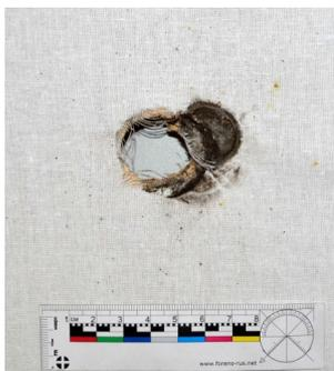
**Рис. 20.** Повреждение и отпечаток пыжа на ткани с подложкой из ДСП при выстреле с расстояния 1000,0 мм
