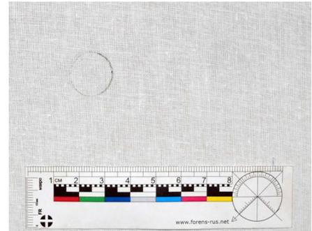
**Рис. 15.** Отпечаток пыжа на ткани с подложкой из ДВП при выстреле с расстояния 5000,0 мм
