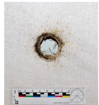
**Рис. 19.** Повреждение ткани с подложкой из ДСП при выстреле с расстояния 500,0 мм
