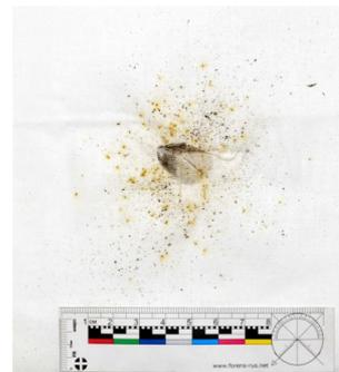
**Рис. 5.** Повреждение и отпечаток пули при выстреле с расстояния 500,0 мм по ткани без подложки
