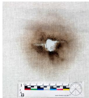
**Рис. 4.** Повреждение ткани с расстояния 100,0 мм по ткани без подложки
