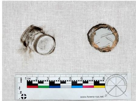
**Рис. 14.** Повреждение и отпечаток пыжа-амортизатора на ткани с подложкой из ДВП при выстреле с расстояния 3000,0 мм
