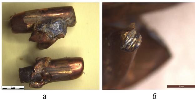
**Рис. 2.** Фрагментированные пули патрона 5,45x39 после пробития ими преграды из магнезита: а – общий вид, ув.  $\times 80$ ; б – вид головной части пули, ув.  $\times 100$
