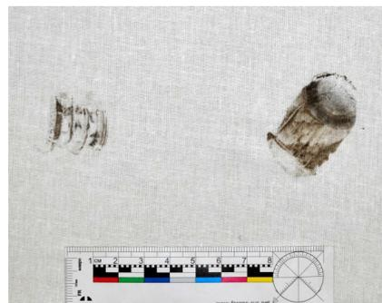
**Рис. 21.** Отпечатки пули и пыжа на ткани с подложкой из ДСП при выстреле с расстояния 3000,0 мм
