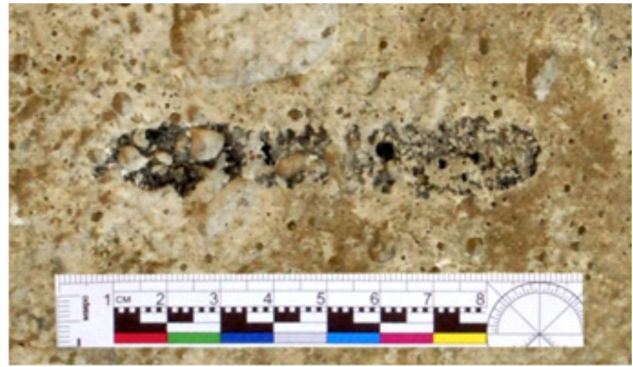
Рис. 1. Вид следа контакта пули, образующегося при поражении под углом 23^\circ эллипсоидной пулей, на поверхности бетонной преграды (ув. 1,5 \times )
