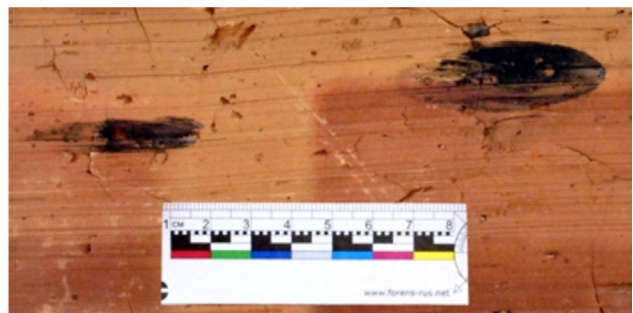
Рис. 2. Вид двойного следа контакта пули, образующегося при поражении под углом 23^\circ сферической пулей, на поверхности кирпичной преграды (ув. 1,5 \times )
