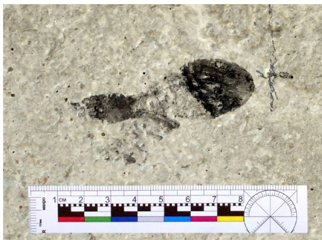
Рис. 1. Вид двойного следа, образованного контактом пули (вверху) и пыжа (снизу) при поражении под углом 45° эллипсоидной пулей поверхности бетонной преграды (ув. x2)
