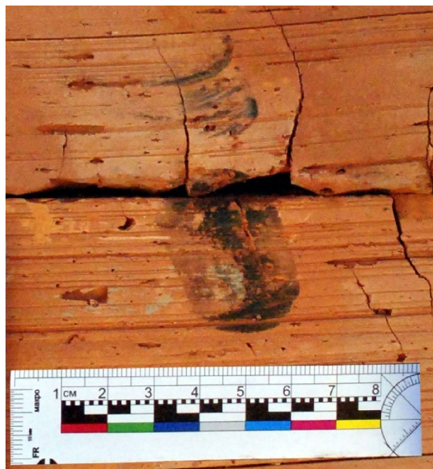
Рис. 2. Вид двойного следа, образованного контактом пули (снизу) и пыжа (сверху) при поражении под углом 45° эллипсоидной пулей поверхности кирпичной преграды (ув. x1,5)
