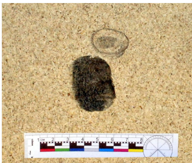
Рис. 3. Вид следов контакта пули и пыжа, образовавшихся при поражении под углом 45° эллипсоидной пулей поверхности преграды из ДСП (ув. x1,5)
