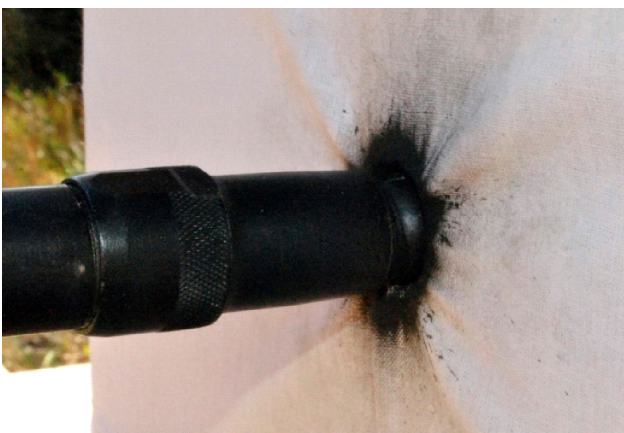
Рис. 16. Вид пули, “застрявшей” между мишенью и срезом ствола, при выстреле в упор по ткани с подложкой из ДСП
