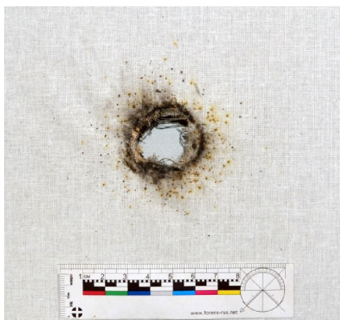
Рис. 20. Вид повреждения и отложения копоти при выстреле с расстояния 500,0 мм по ткани с подложкой из ДСП
