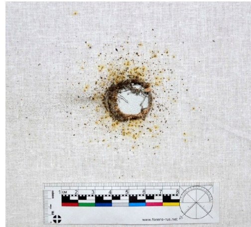
Рис. 13. Вид повреждений и отложения копоти при выстреле с расстояния 500,0 мм по ткани с подложкой из ДВП
