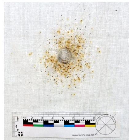
Рис. 5. Вид повреждения и отложения копоти при выстреле с расстояния 500,0 мм по ткани без подложки
