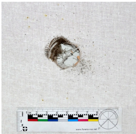
Рис. 14. Вид повреждения и краевого отпечатка пыжа копоти при выстреле с расстояния 1000,0 мм по ткани с подложкой из ДВП
