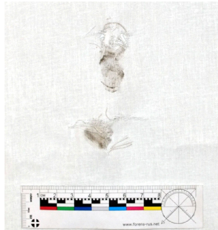
Рис. 7. Вид повреждений и отложения копоти при выстреле с расстояния 3000,0 мм по ткани без подложки
