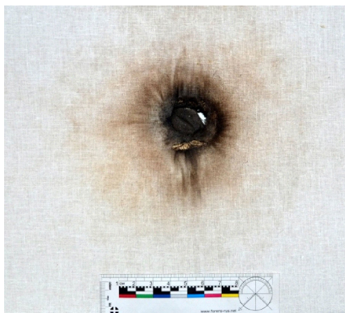
Рис. 18. Вид повреждения и отложения копоти при выстреле с расстояния 50,0 мм по ткани с подложкой из ДСП
