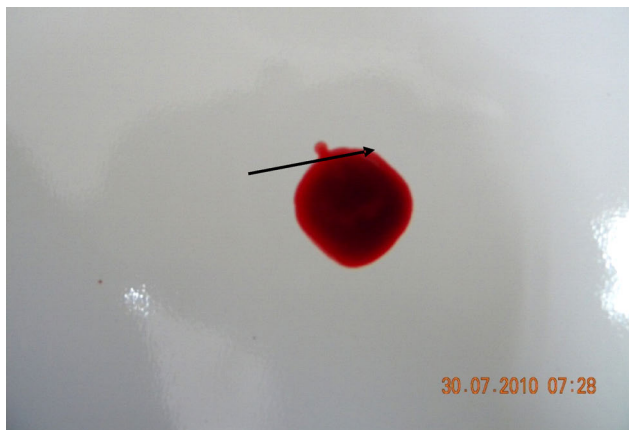
Рис. 7. Длительное давление квадратным бойком слесарного молотка, следовоспринимающая поверхность – бумажные обои с ровной поверхностью, контуры отпечатков четкие, края ровные (стрелкой указан низкоскоростной элемент – прямолинейный короткий и узкий “динамический потек”)
