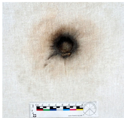
Рис. 19. Вид повреждения и отложения копоти при выстреле с расстояния 100,0 мм по ткани с подложкой из ДСП
