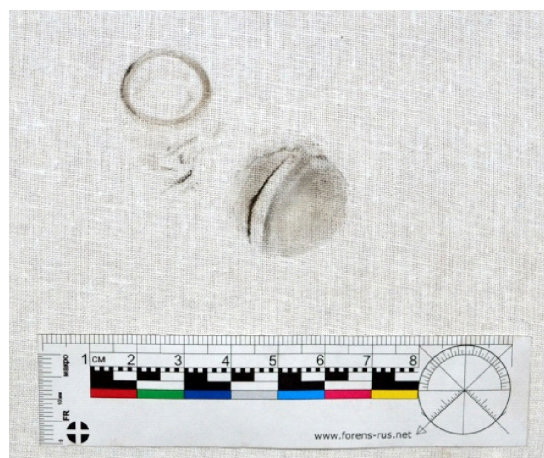
Рис. 23. Вид отпечатков пули и пыжа при выстреле с расстояния 5000,0 мм по ткани с подложкой из ДСП
