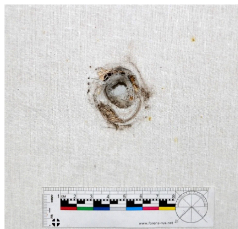
Рис. 21. Вид повреждения и отложения копоти при выстреле с расстояния 1000,0 мм по ткани с подложкой из ДСП
