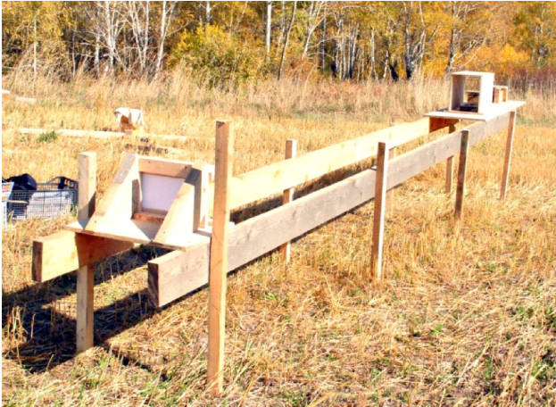
Рис. 1. Общий вид стационарного, модульного стенда в варианте комплектации проведения отстрелов для поражения преград по прямой траектории
