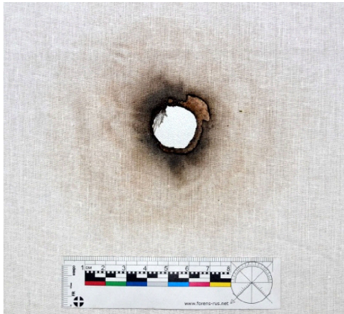
Рис. 12. Вид повреждения и отложения копоти при выстреле с расстояния 100,0 мм по ткани с подложкой из ДВП
