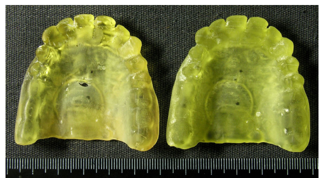
Рис. 4. Стереолитографические копии протеза верхней челюсти Е.С. Боткина
