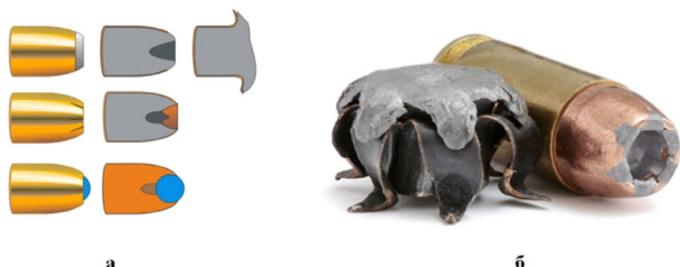
Рис. 1. Экспансивные пули. Схематическое изображение в разрезе (а) и общий вид (б): а – (сверху вниз): пуля с полостью в головной части; пуля с полостью в головной части и оболочкой, механически соединенной с сердечником; пуля с экспансивной пробкой в виде шарика (медь, лигированные сплавы); б – стреляная экспансивная пуля .40 S&W вместе с патроном того же калибра
