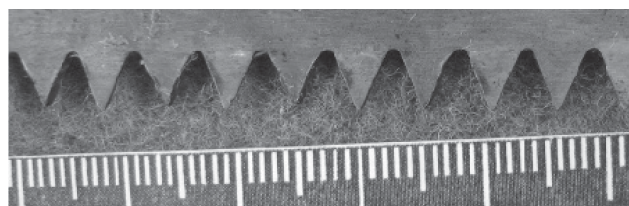
Рис. 3. Шаг и высота зубцов полотна ножовочной пилы
