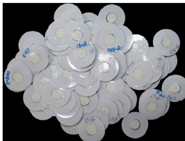
Рис. 3. Подготовленные к исследованию методом РСФА “таблетки”
