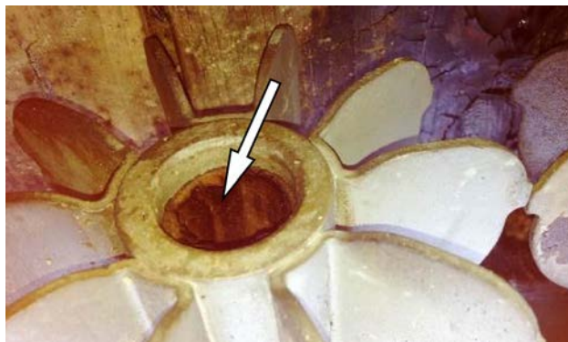
Рис. 12. На месте взорвавшегося воспламенительного заряда в трубке стабилизатора мины сохранилась картонная часть гильзы (указана стрелкой), а ее латунное основание отсутствует
