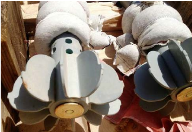
Рис. 5. Вид стабилизаторов 120-мм мин со вставленными основными зарядами и надетыми дополнительными пучками заряда
