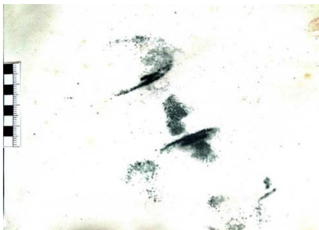
Рис. 17. Положительный результат исследования следов копоти контактно-диффузионным методом на медь
