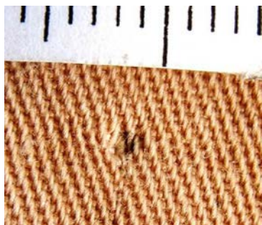
Рис. 18. Поверхностное повреждение ткани брюк Б. от действия частицы непрореагировавшего взрывчатого вещества
