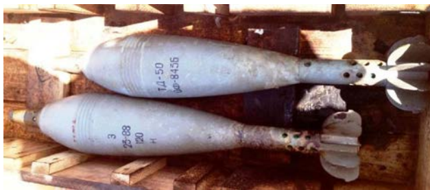
Рис. 11. Мины в парковом ящике после происшествия (вверху осколочно-фугасная, внизу зажигательная). Дополнительные пучки вышибных зарядов полностью выгорели. Дно ящиков под стабилизаторами мин с признаками обгорания
