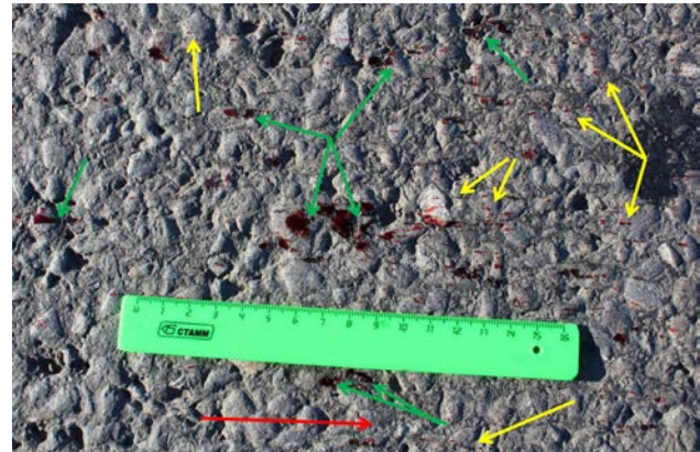
Рис. 7. Неровная непитывающая поверхность (асфальт) – скорость движения 60 км/ч, внутренний диаметр слива 0,4 см (красная стрелка – направление движения автомобиля, зеленые – зубцы с закругленными концами, желтые – вторичные брызги)
