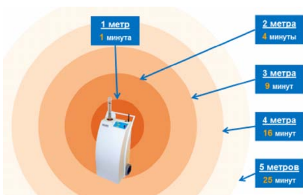
Рис. 4. Обеззараживание поверхностей с помощью установки УИК-01-«Альфа» от госпитальной микрофлоры с эффективностью 99,99% (включая полирезистентные штаммы MRSA, VRE, Clostridium difficile)
