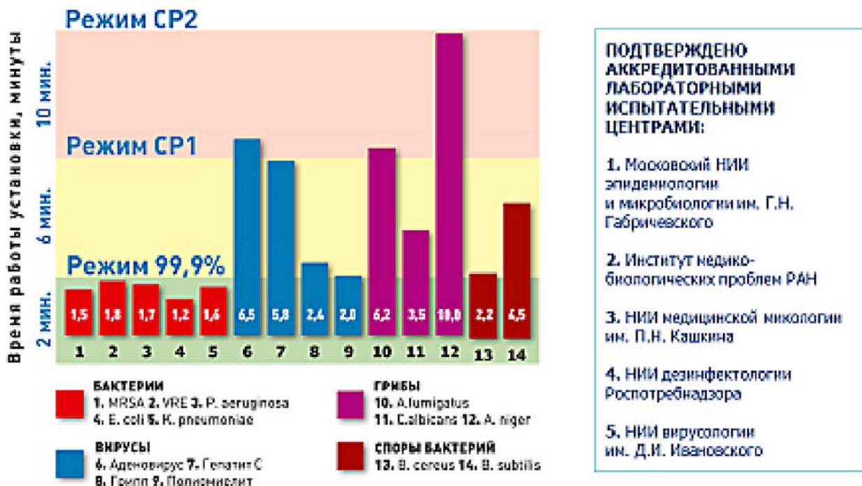
Рис. 3. Время и режимы обеззараживания установкой УИК6-01-«Альфа» воздуха помещения 100 м³ от микрофлоры с эффективностью 99,9–99,99%
