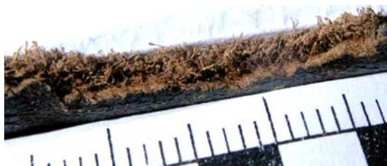
Рис. 9. Вид поверхности разрыва ремня крупным планом (масштабная линейка помещена у лицевого края разрыва)
