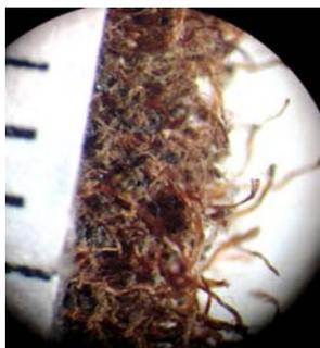
Рис. 8. Микрофотографии фрагментов краев разрыва ремня с изнанки
