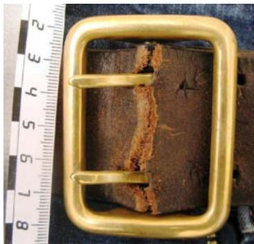
Рис. 2. Разрыв поясного ремня М. в "рабочем" положении ремня
