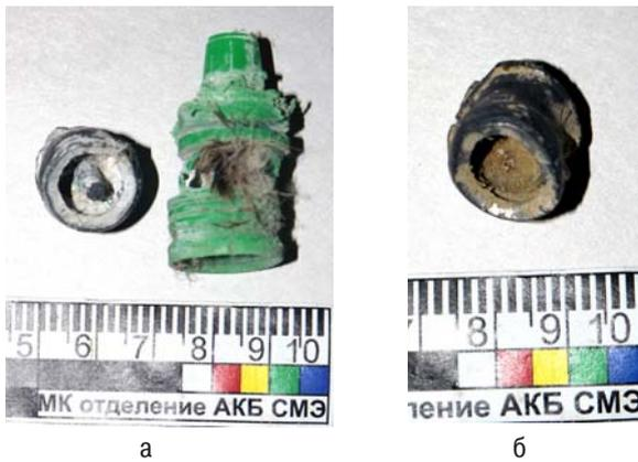
**Рис. 1.** Материалы для исследования: деформированные пуля № 1 и пыж-стабилизатор, изъятые из стены (а); деформированная пуля № 2, изъятая из стены (б)
